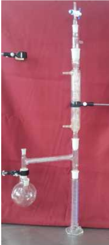
Equipo de destilación al vacío: Diseñado por Bernardino Ramírez Durand, docente de la Facultad de Ingeniería Química. El equipo se encuentra ubicado en el Laboratorio de Investigación II.
