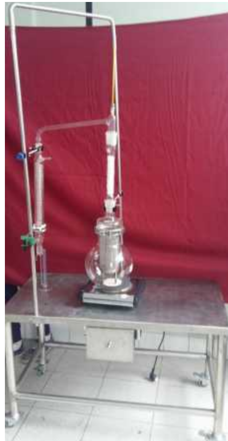
Equipo de extracción de aceites esenciales: Diseñado por Luis Carrasco Venegas y Bernardino Ramírez Durand, docentes de la Facultad de Ingeniería Química de la UNAC. Ha contribuido a varias tesis de extracción de aceites esenciales. Tiene la capacidad de realizar un fraccionamiento simultáneo. El equipo se encuentra ubicado en el Laboratorio de Investigación II.
